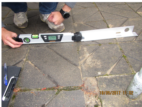
Fotofiksācija Nr.11 Nav izbūvēts atbilstošs panduss, iekļūšanai ēkā cilvēkiem ar ratiņkrēsliem
